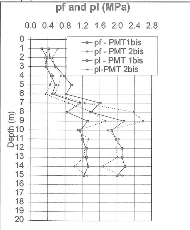
Figure 10 : PMT Result : Pressures  $pf$  &  $pl$  [MPa]
