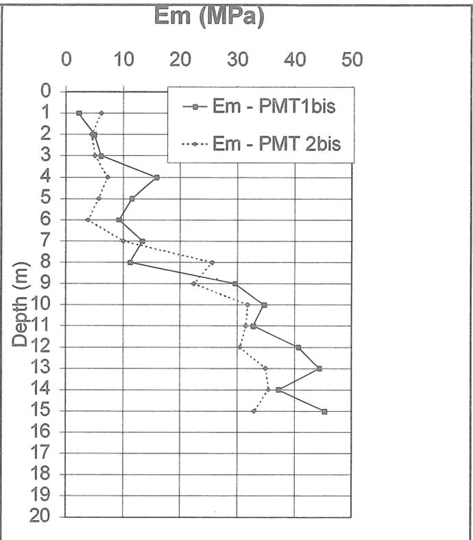
Figure 11 : PMT Result : module  $E_m$  [MPa]
